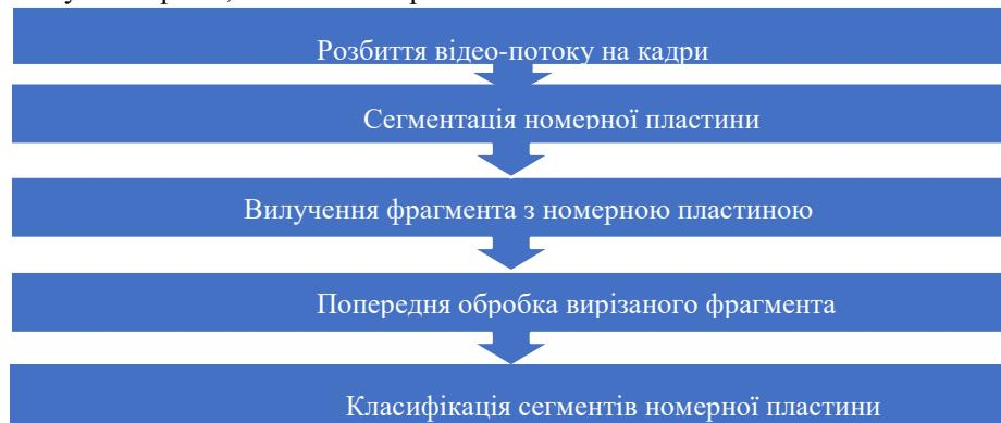
**Рис. 1.** Загальна схема розв'язання задачі розпізнавання автомобільного номерного знаку
